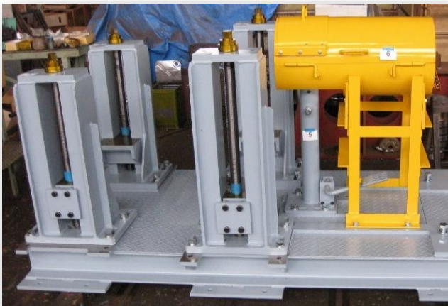
エンジンマウント、移動式共通架台
