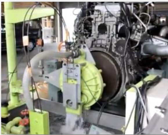
エンジンマウント、移動式共通架台
